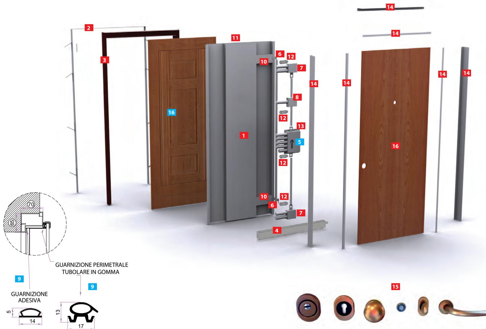
**1** Omega verticale in lamiera di acciaio zincato di larghezza 55 cm altezza 210 cm e di spessore 1 mm
